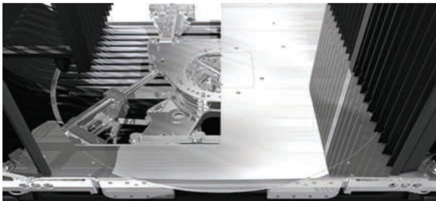
Fot. 10. Przymocowany do obrotnicy siłownik hydrauliczny odpowiada za to, by system się nie zginał zbyt szybko za maksymalny kąt zgięcia systemu, a także za blokadę przegubu, co jest szczególnie ważne podczas cofania.
