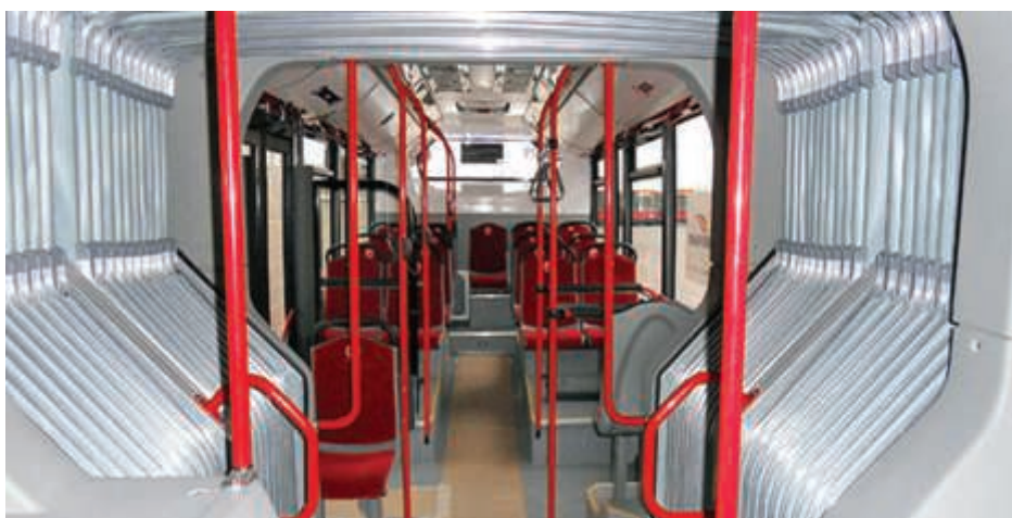
Fot. 6. Opończa przegubu widziana z wnętrza pojazdu. W środku zostały zamontowane dodatkowe poręcze dla podróżnych.
