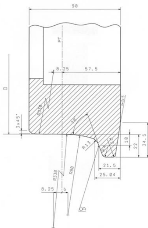
Rys. 3. Kontur bieźnik koła typu PST.
