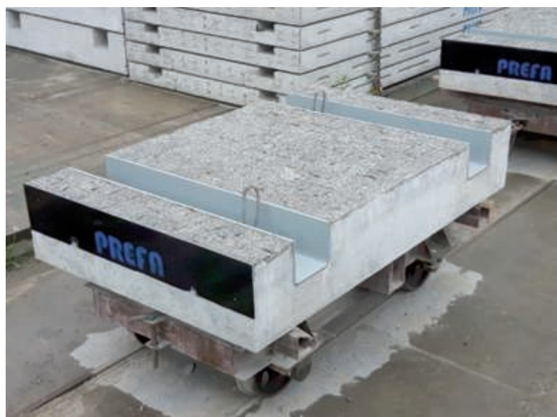
Fot. 2. Gotowy prefabrykat VRZB (płyta torowa) firmy Prefa Sp. z o.o. ►
