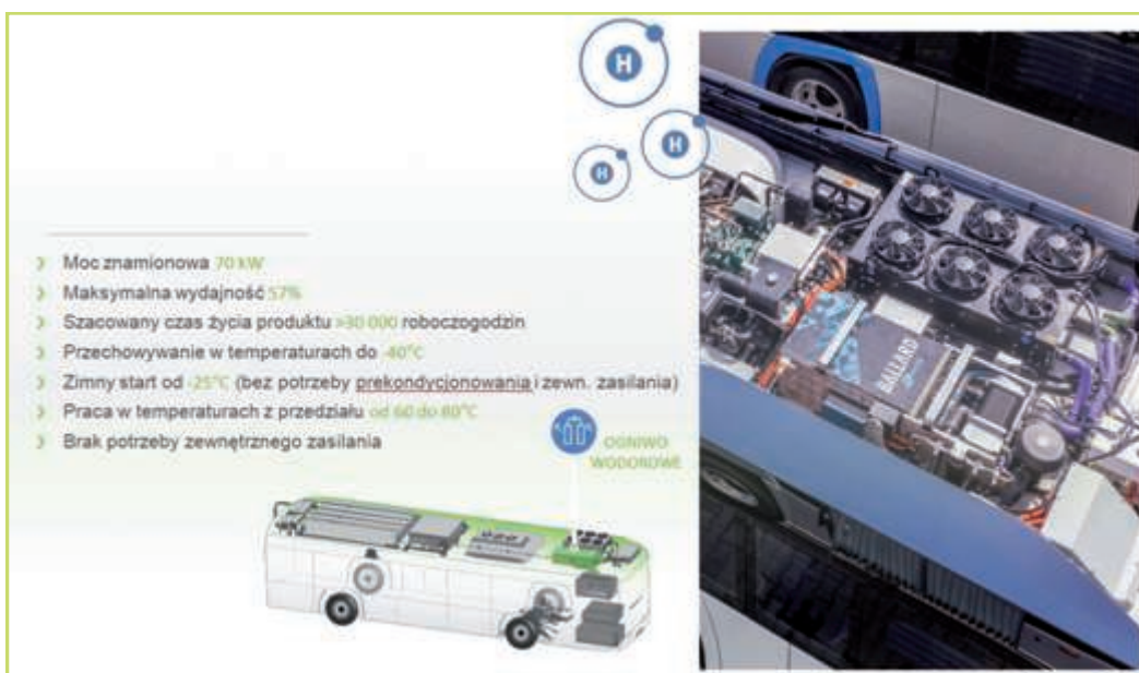
Rys. 3. Ogniwo wodorowe FCmove-HD nowej generacji.
