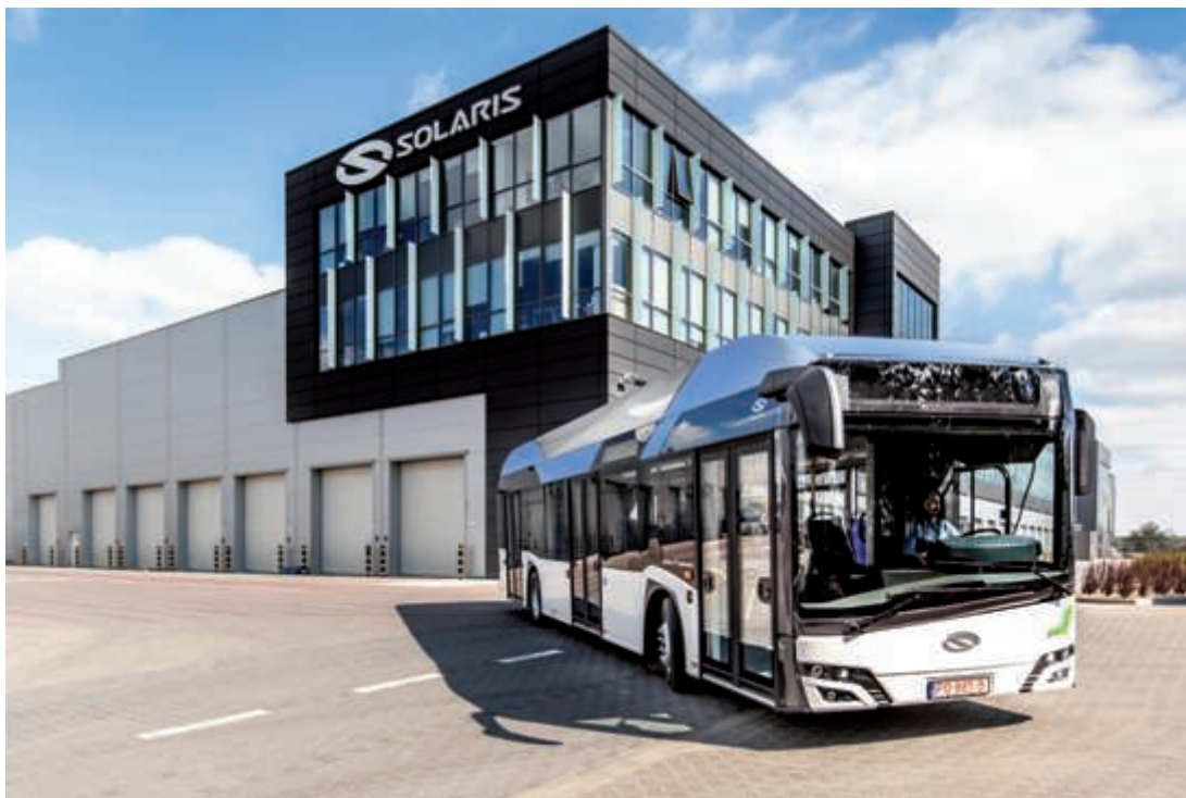
Fot. 1. Solaris Urbino 12 hydrogen to pojazd całkowicie bezemisyjny, w którym wodór w ogniwie paliwowym przekształcany jest w energię elektryczną, a ta z kolei zasila układ napędowy pojazdu.
