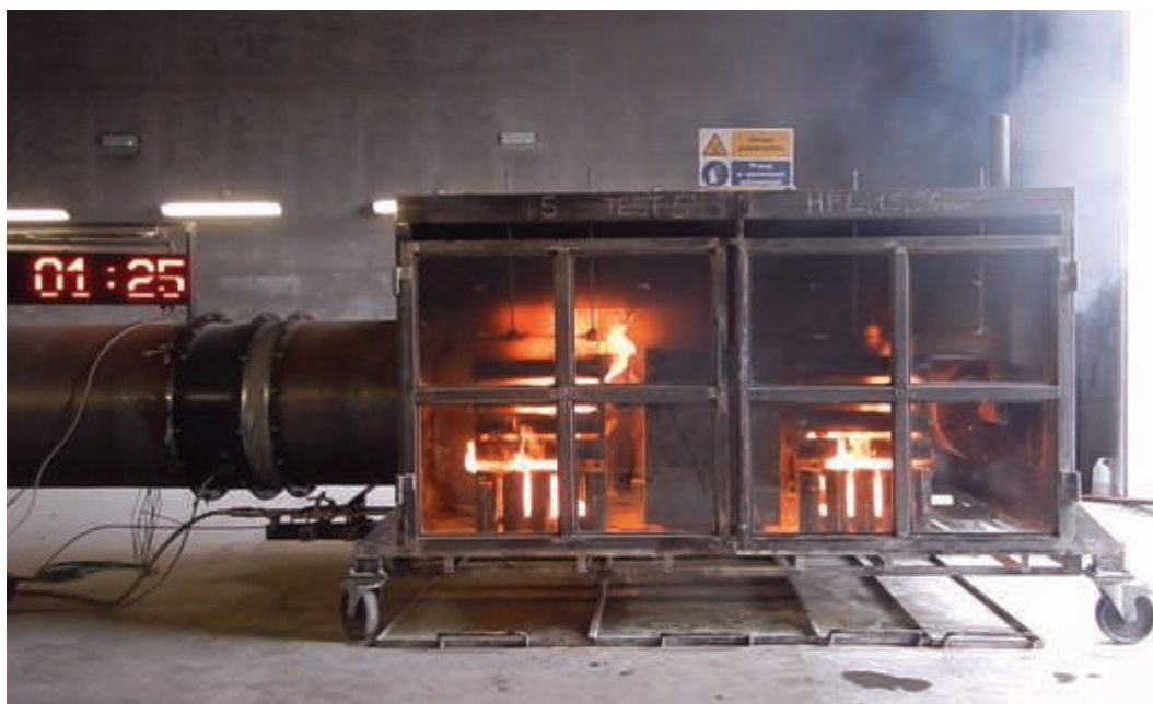
Fot. 1. Komora testowa posiada szereg żebrowań, które mają utrudniać dostęp środka gaśniczego do płonących kuwet.
