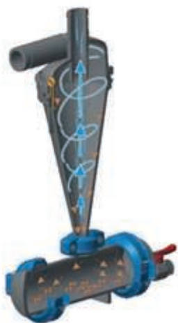
Rys. 3. Jeden z etapów procesu uzdatniania wody – filtr odśrodkowy (hydrocyklon).
