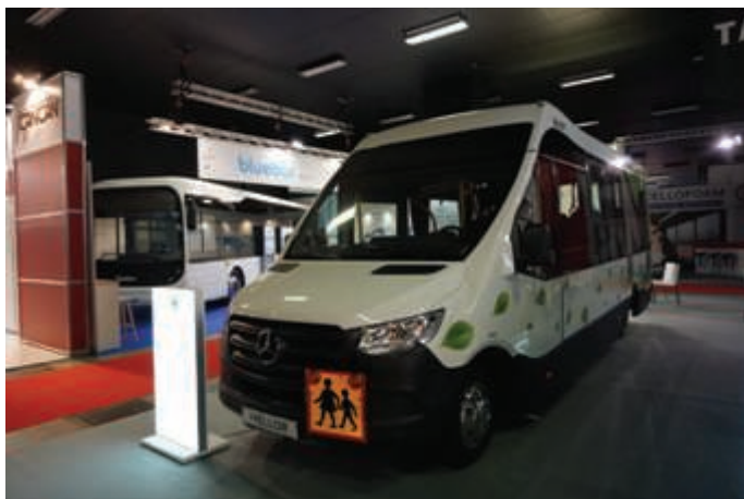
Fot. 19. Minibus Mellora na podwoziu samochodu dostawczego Mercedes-Benz Sprinter odróżniał się od całej stawki pojazdów zabudową podwozia o szerokości 2,4 m.
