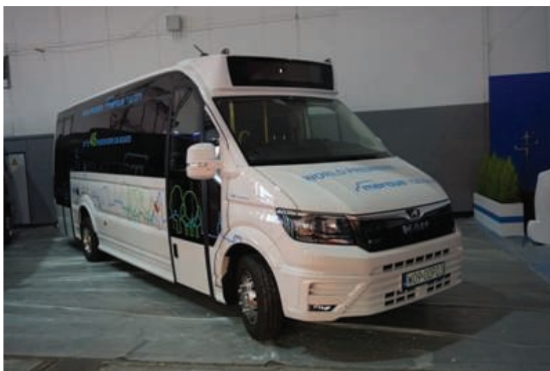
Fot. 16. Mercus TGE City, w którym niską podłogę zlokalizowano na zwisie tylnym, mimo niewielkich wymiarów może zabrać na pokład aż 45 pasażerów.
