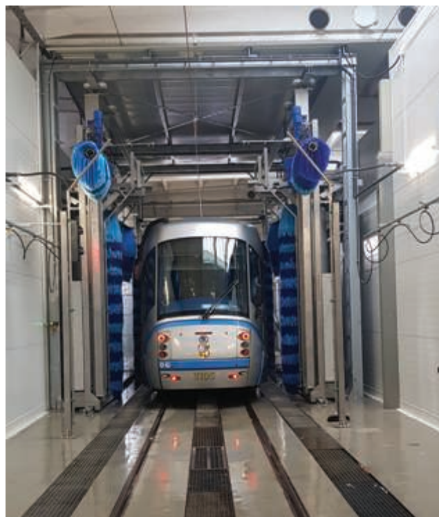
Fot. 6-7. Przykłady myjni portalowych - myjnia autobusowa w Opolu (fot.6) oraz myjnia tramwajowa we Wrocławiu (fot. 7). Portale poruszają się po szynach wzdłuż stojącego taboru, a trakcja na czas mycia jest automatycznie wyłączana. Takie myjnie charakteryzują się mniejszą przepustowością. ▲ ►
