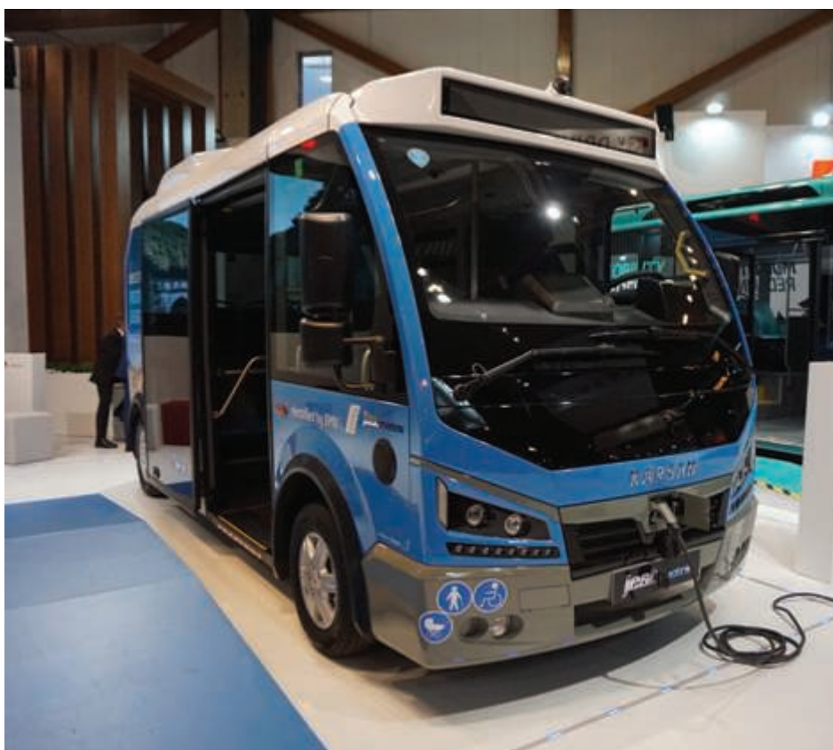
Fot. 25. Niskopodłogowy minibus Karsan Jest z napędem elektrycznym, przystosowany do przewozu 25 pasażerów, ma zasięg w zależności od wybranej opcji baterii od 105 do 210 km.
