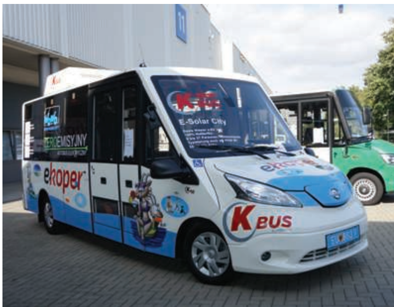
Fot. 22. Elektryczny minibus K-Bus E-Solar City z niską podłogą na całej długości autobusu oraz z fotowoltaicznym ekstenderem.
