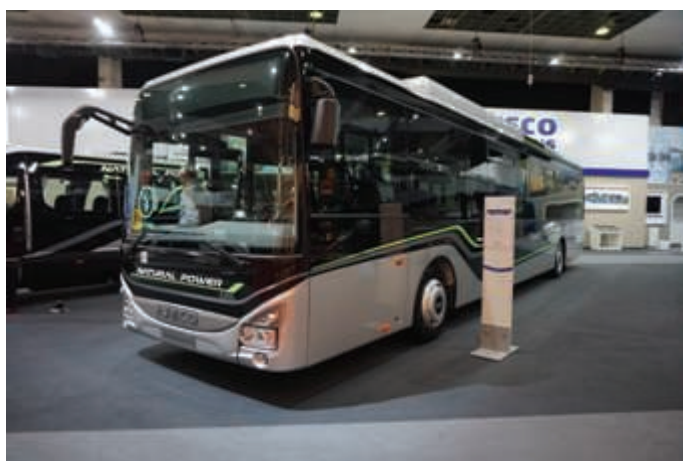
Fot. 10. Iveco Crossway LE Natural Power – niskowejściowy autobus z napędem CNG doskonale nadaje się do obsługi tras podmiejskich.
