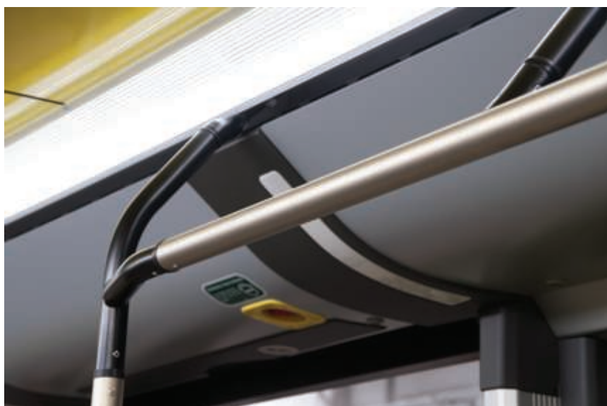
Fot. 2. Kompozytowe orurowanie, wykonane z materiałów posiadających naturalne właściwości antimicrobial.
