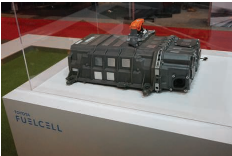
Fot. 31. Ogniwo paliwowe Toyoty montowane w autobusie Caetano.
