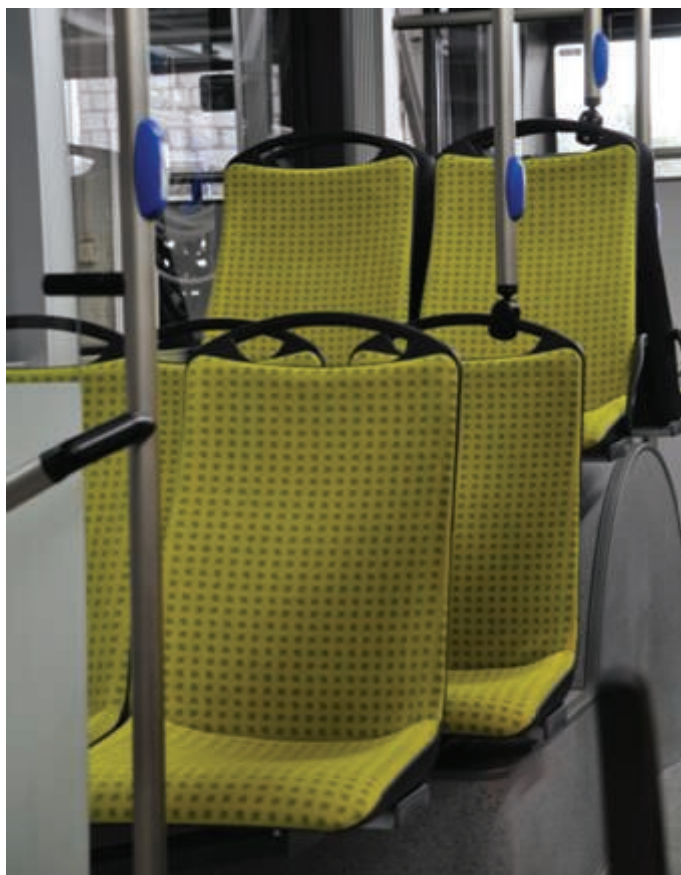
Fot.1. Autobus Solaris Urbino 12 electric nagrodzony tytułem Bus of the Year w 2016 r. – wyposażony w orurowanie wykonane z kompozytu z wykorzystaniem miedzioniklu CU plus oraz siedzenia wykonane z tworzywa antimicrobial.
