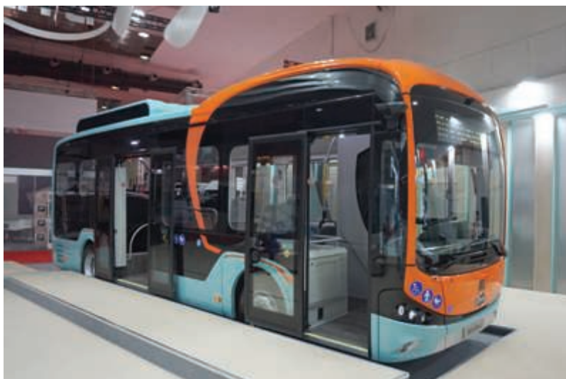
Fot. 4. BYD C8, w którym zabudowano system elektronicznych lusterek zewnętrznych.
