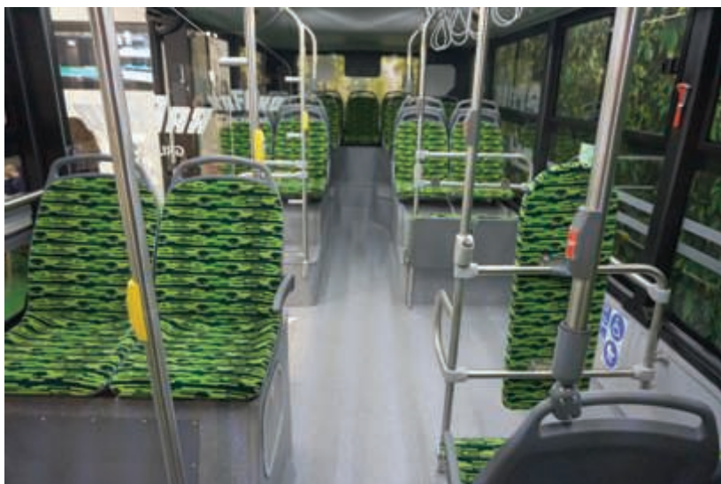
Fot. 3. Dzięki zabudowie baterii w ścianach pod podłogą, z wnętrza udało się wyeliminować większość podestów.
