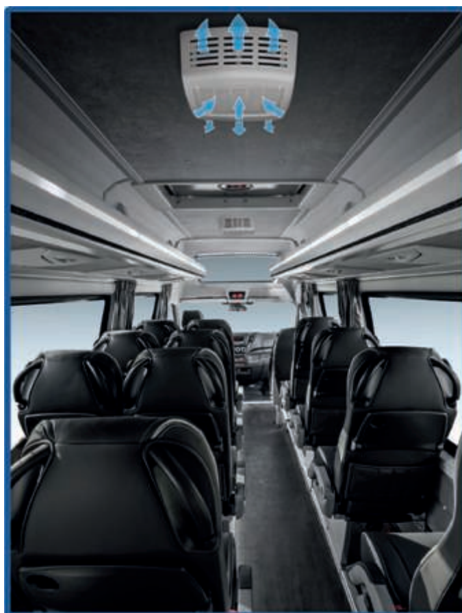
Fot. 2. Niewielki pobór mocy pozwala na zamontowanie kilku urządzeń filtrujących w autobusach i tramwajach.
