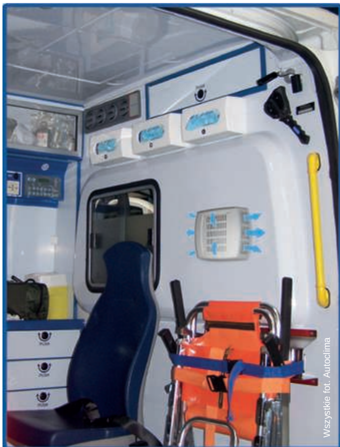
Fot. 1. Urządzenia filtrujące powietrze Saniclimafilter od początku były przeznaczone do karet pogotowia obsługujących pacjentów zakażonych koronawirusem.
