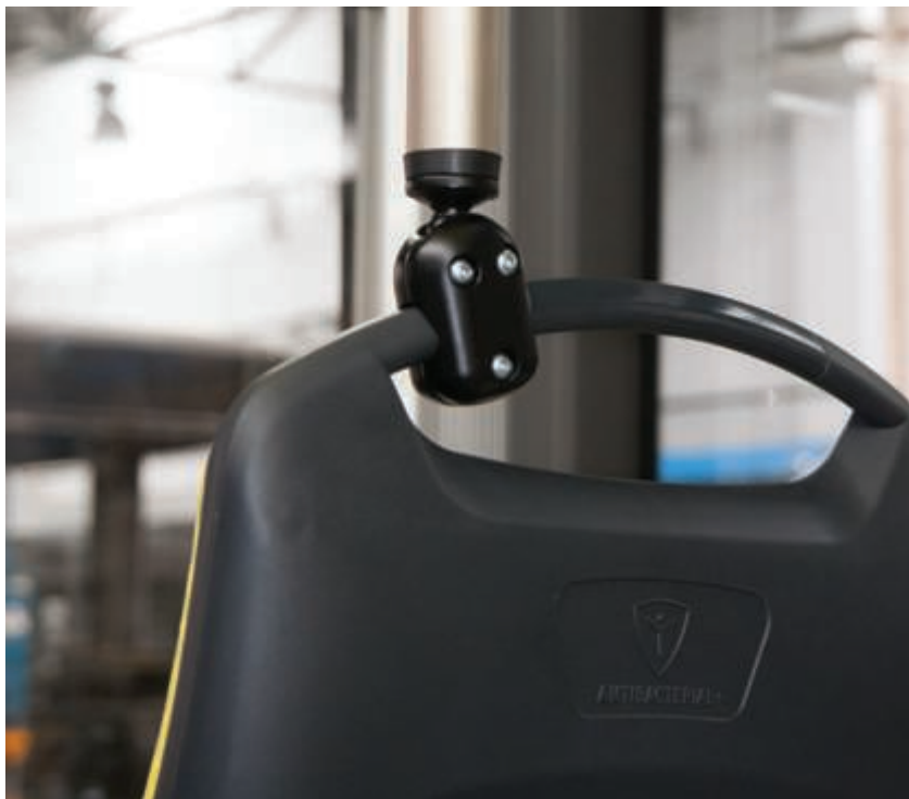
Fot. 3. Fotel pasażerski autobusu miejskiego wykonany z materiałów anti-microbial.
