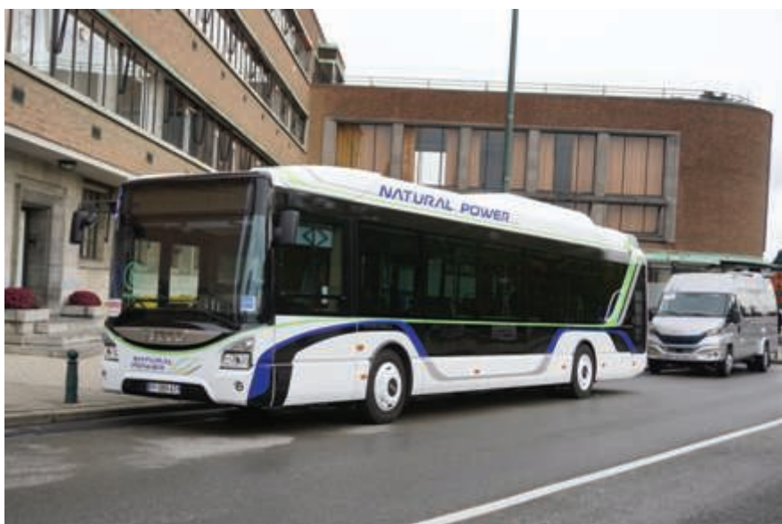
Fot. 10. ...oraz gazowy Iveco Urbanway 12 Natural Power.
