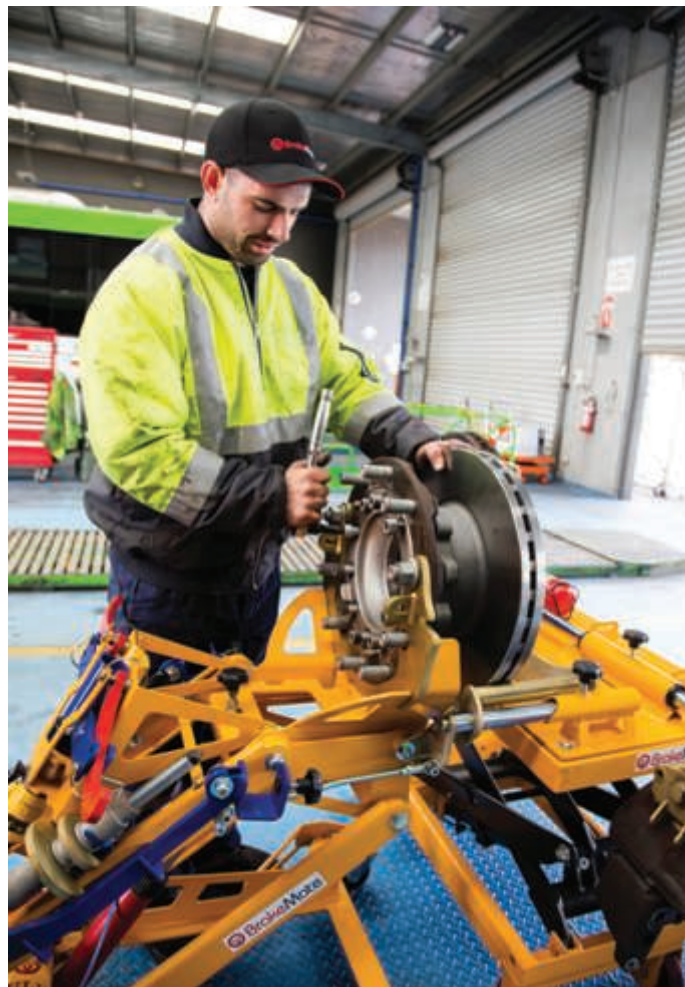
Fot. 3. Wszystkie prace związane z serwisem hamulców wykonywane są przy wyprostowanych plecach.
