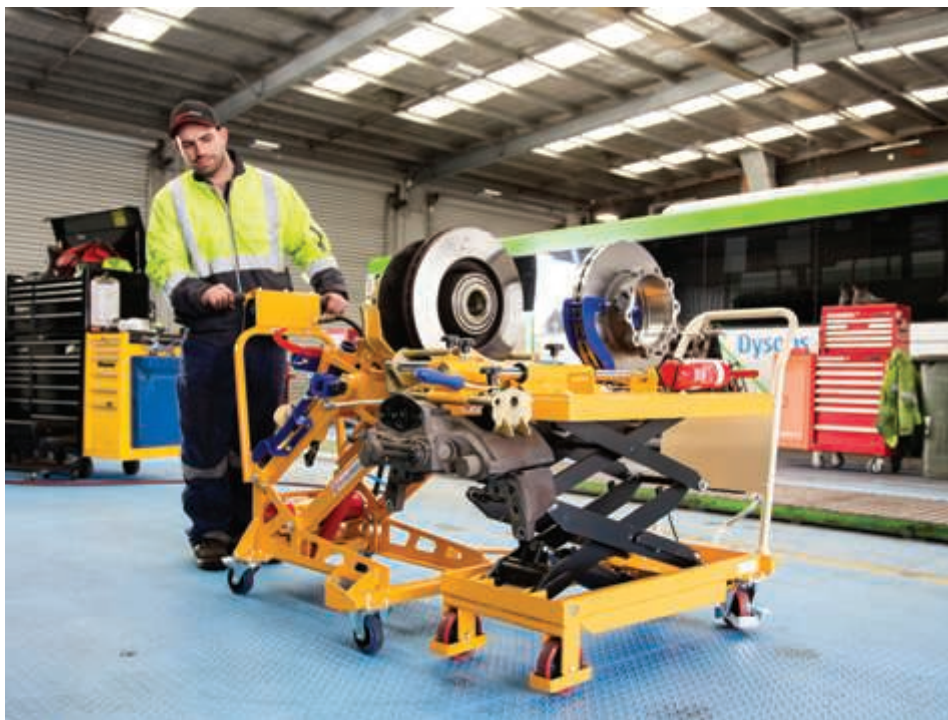
Fot. 2. Brake Mate składa się z dwóch mobilnych stołów roboczych.
