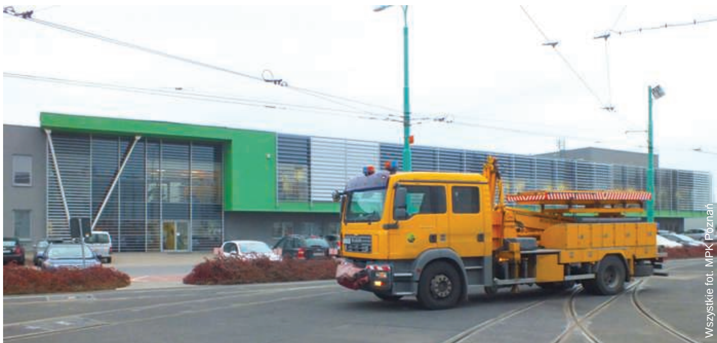
Fot. 1. Pojazd specjalny do usuwania awarii napowietrznej sieci trakcyjnej wykorzystywany przez MPK Poznań.
