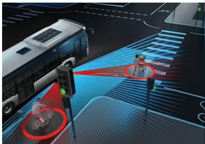
Rys. 2. Sideguard Assist bazuje na dwukierunkowym czujniku, który skanuje przestrzeń po prawej stronie pojazdu i informuje kierowcę, gdy w jego zasięgu znajdzie się obiekt nieruchomy lub ruchomy. Jest zatem bardzo przydatny w gęstym ruchu miejskim z dużą liczbą poruszających się pieszych, rowerzystów czy osób na hulajnogach.
