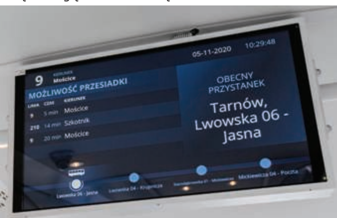
Fot. 7. W każdym autobusie na ekranie LCD wyświetlane są informacje o numerze linii, kierunku i godzinie odjazdu innych autobusów, które przyjadą w ciągu 30 minut na najbliższy przystanek.
