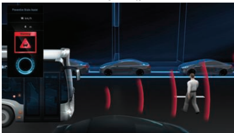
Rys. 1. Preventive Break Assist rozpoznaje obiekty pojawiające się przed pojazdem, w tym pieszych. Po rozpoznaniu zagrożenia, na desce rozdzielczej pojawia się komunikat oraz rozlega się dźwięk ostrzegawczy. Następnie, dla bezpieczeństwa pasażerów, system inicjuje częściowe hamowanie.
