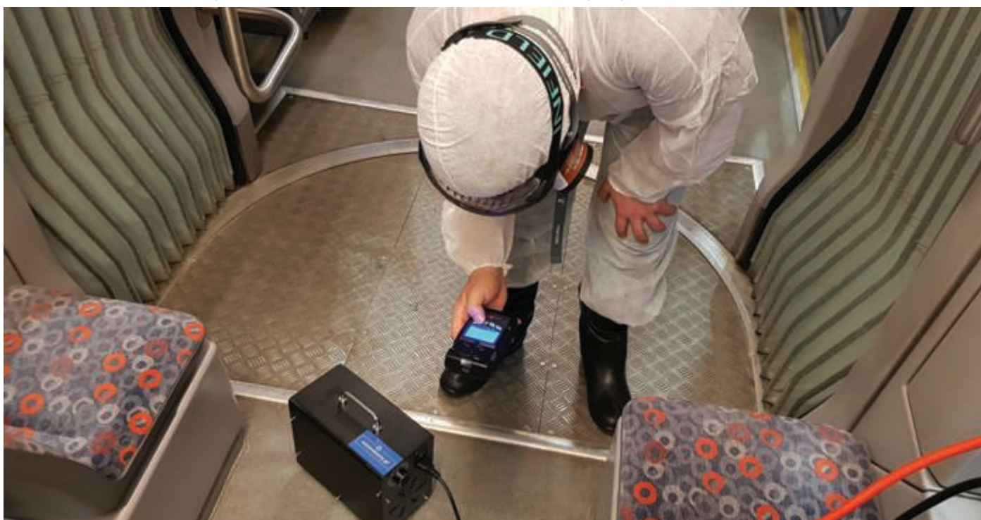
Fot. 2. Ozonowanie tramwajów przed uruchomieniem w nich ponownie klimatyzacji.
