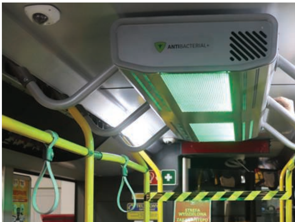
Fot. 3. Oczyszczacz powietrza firmy STER testowany w jednym z łódzkich autobusów.
