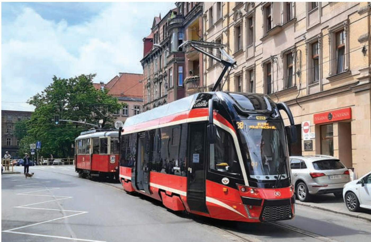
Fot. 4. Nowy, niskopodłogowy, dwukierunkowy, wyposażony w nowoczesne urządzenia wagon Moderus poznańskiej firmy Modertrans wprowadził nową jakość na linii 38. Władze miasta zapewniają jednak, że stare „e-Nki” nie znikną z krajobrazu Bytomia. Po złagodzeniu rygorów sanitarnych będą kursowały na przemian z tramwajem niskopodłogowym. W ten sposób, zgodnie z powiedzeniem: „I wilk syty, i owca cała”, troszcząc się o zachowanie niepowtarzalnego klimatu ulicy Piekarskiej, zadbano jednocześnie o komfort starszych i niepełnosprawnych pasażerów.
